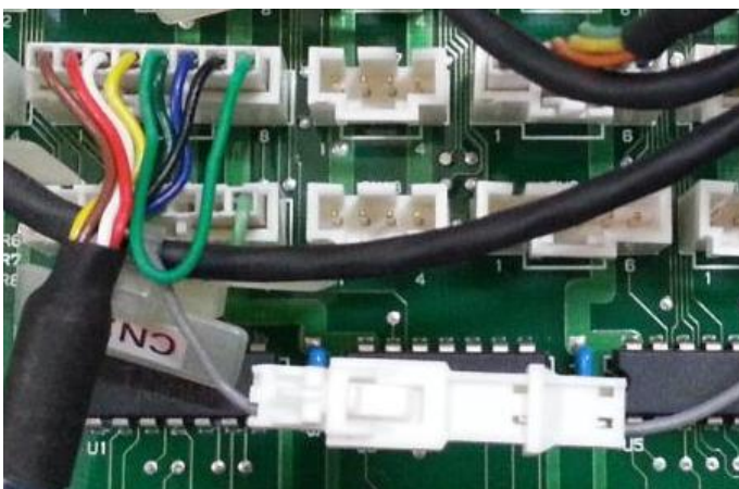
Talon I/F Board 구성 모습
