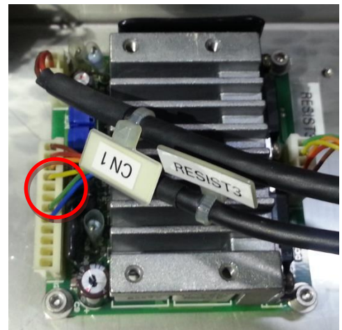
기존 RRC Driver 구성 모습
